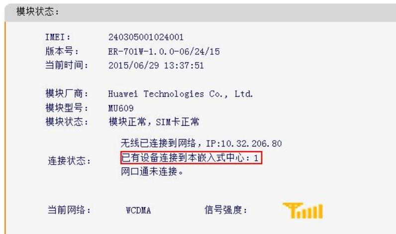
图附 6-7: 路由器状态显示 DTU 已连入嵌入式数据中心
