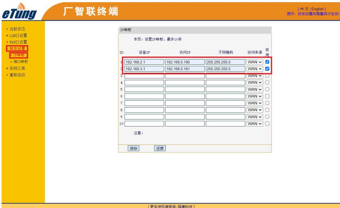
这样，两台不同 IP 网段的设备通过 FIC-203 的 IP 映射，被统一映射到相同的 IP 网段：192.168.0.\*，之后局域网内的电脑（或其他设备）就可以通过映射后的访问 IP 对设备进行访问了。
