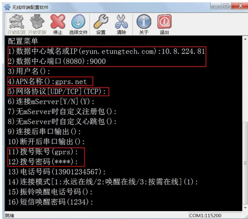
图附 6-5: 配置 DTU 数据中心地址和 APN 参数
