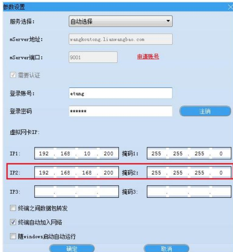
图附 2-9: 设置 Loopback 网卡远程访问 IP
