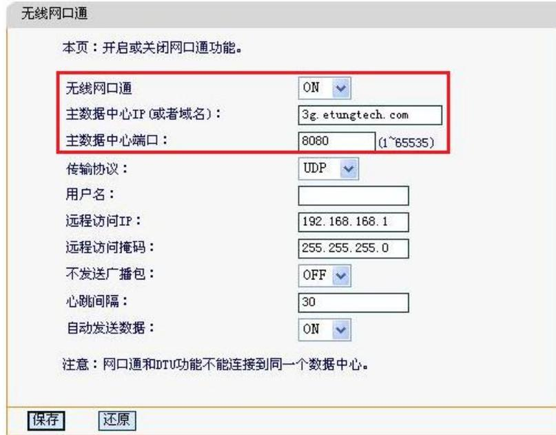
5. 上位机电脑运行网口通，设置虚拟网卡 IP 与下位机映射的地址在同一网段：
