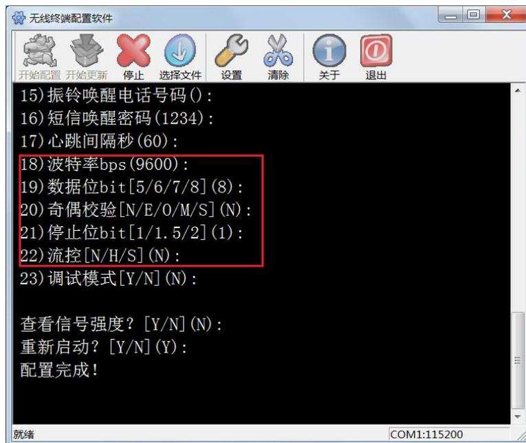
图附 6-6: 配置 DTU 串口参数
