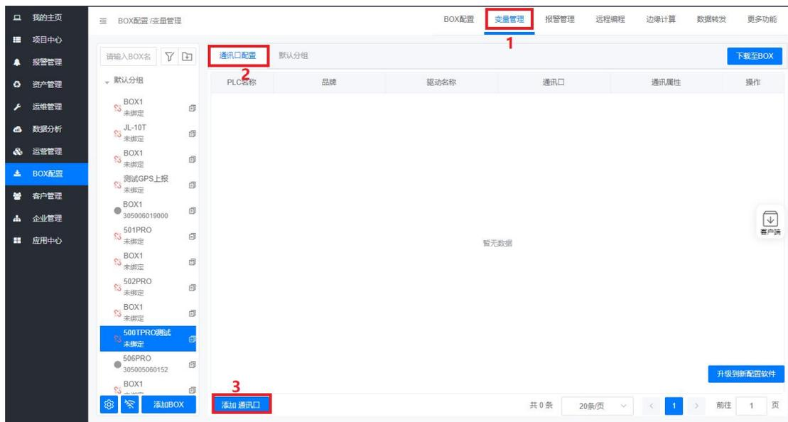
配置 RS485 串口采用 MODBUS RTU 协议，MODBUS Slave 从站 ID，同时配置 RS485 串口的波特率、数据位、校验位和停止位，与所连的设备串口参数一致：
