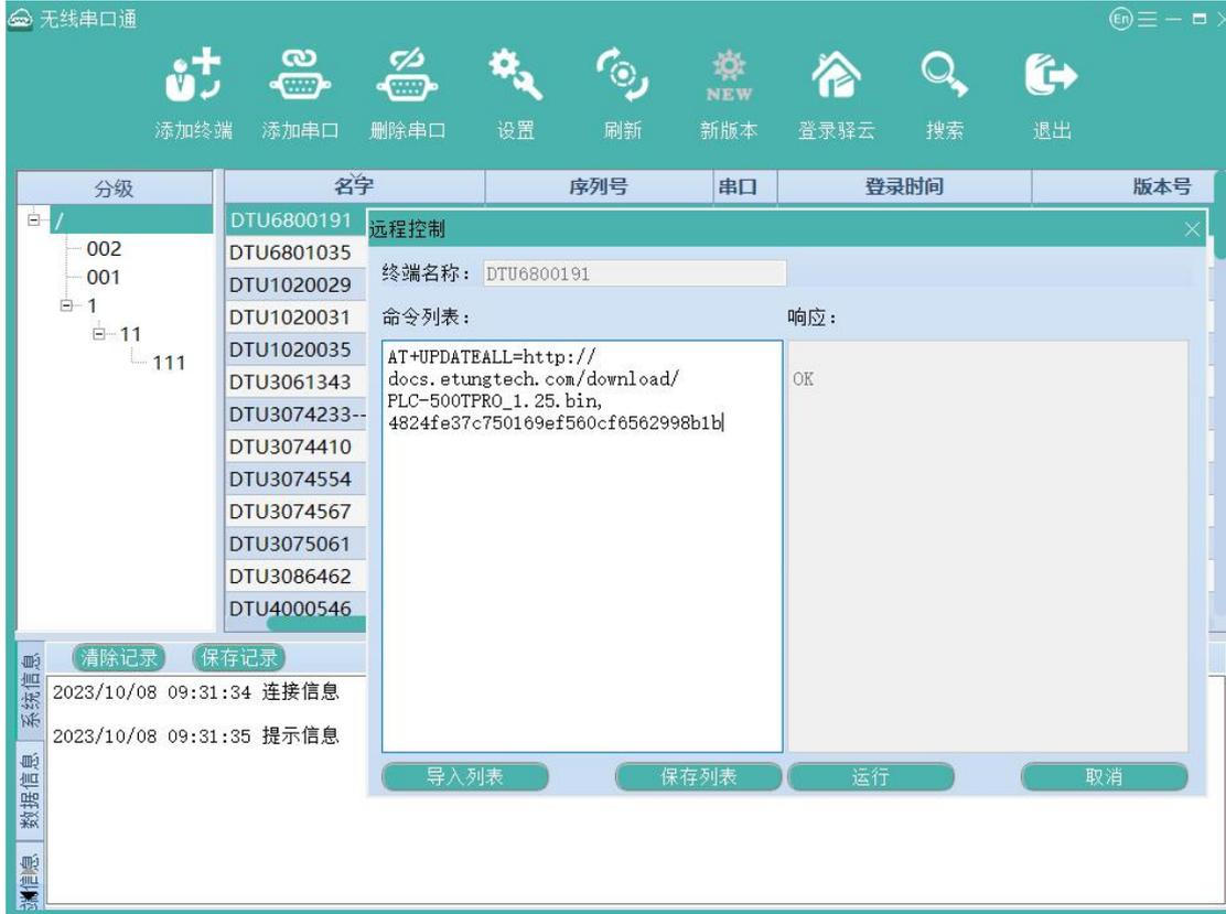
**注意：**使用 **AT+UPDATEALL** 更新固件后，原有配置被清除，PLC-500TPRO 重新连上云平台后，需要点击数据同步重新下载配置。
