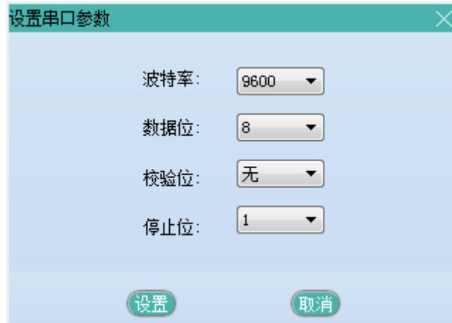
图附 2-9: 修改终端串口参数
