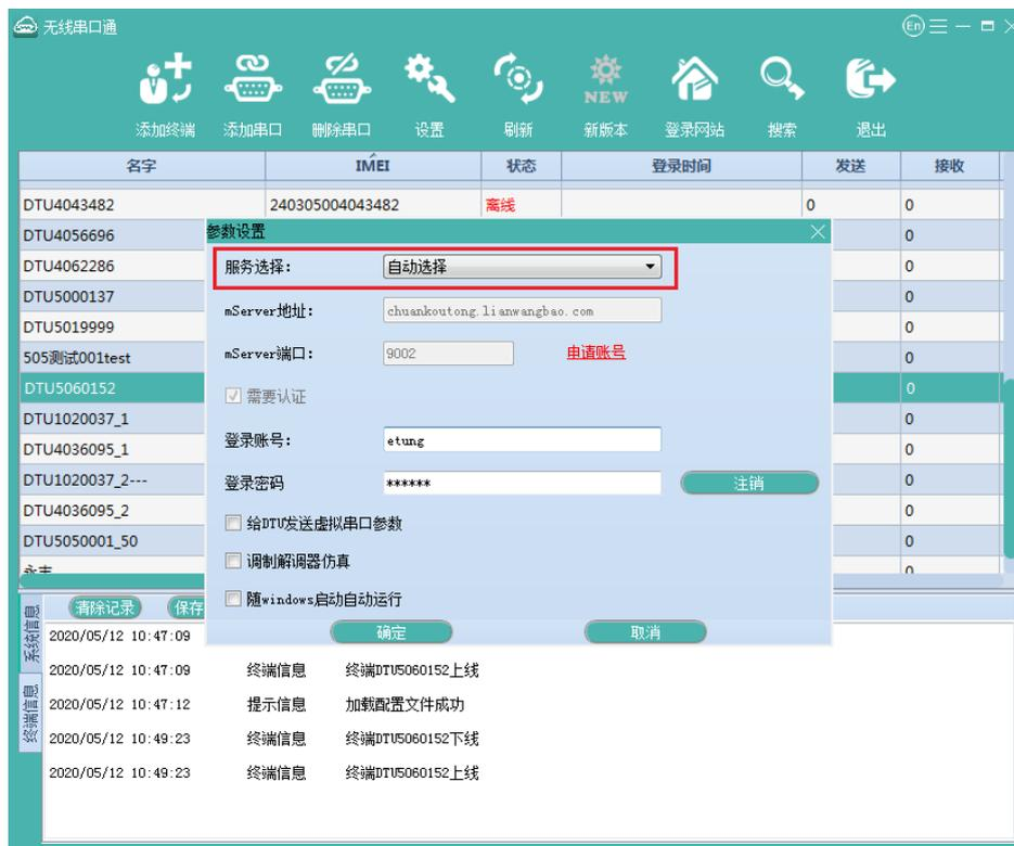
图附 2-5：配置串口通软件，选择服务器
